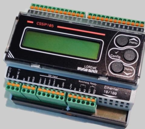
Le CSSIP105 est un convertisseur série parallèle permettant la retransmission (sous forme binaire ou Gray) parallèle d'un codeur absolu SSI, l'afficheur permet un diagnostic rapide du bon fonctionnement (affichage du signal d'entrée, de l'échelle physique associée et de l'état des sorties).
